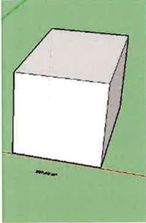
Le volume protégé d'un logement reprend tous les espaces du logement que l'on souhaite protéger des déperditions thermiques que ce soit vers l'extérieur, vers le sol ou encore des espaces non chauffés (cave, annexe, bâtiment mitoyen...). Il comprend au moins tous les locaux chauffés. Lorsqu'une paroi dispose d'un isolant thermique, elle délimite souvent le volume protégé.
